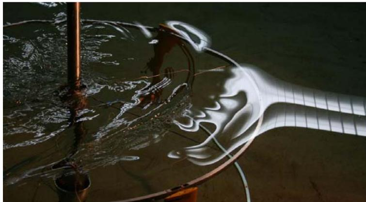
Abbildung 42: Verformung der Wasseroberfläche bei minimaler Tauchung
