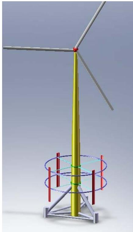
**Abbildung 33: Gesamtstruktur H-Rotor mit Tripod-Gründung**
