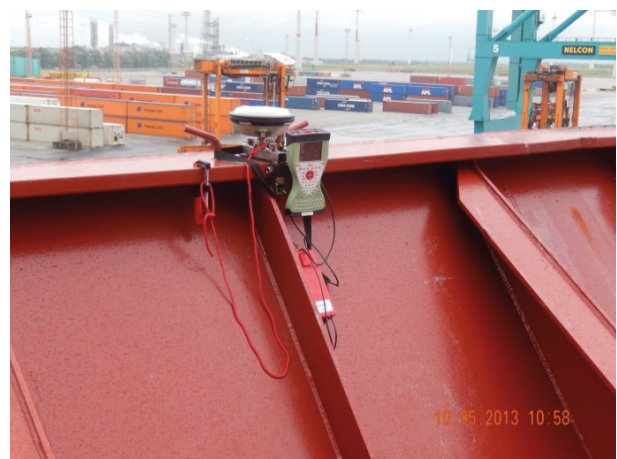
Abbildung 3: Installation der GNSS-Empfänger auf den Nocken (links) und am Bug (rechts)
