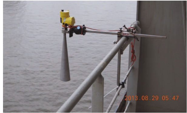
Abbildung 4: Installation des Radarpegels an der Reling (hier: am Bug)
