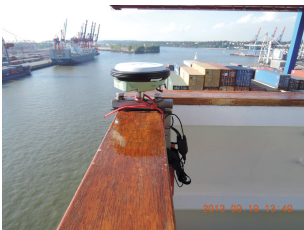
Abbildung 3: Installation der GNSS-Empfänger auf den Nocken (links) und am Bug (rechts)
