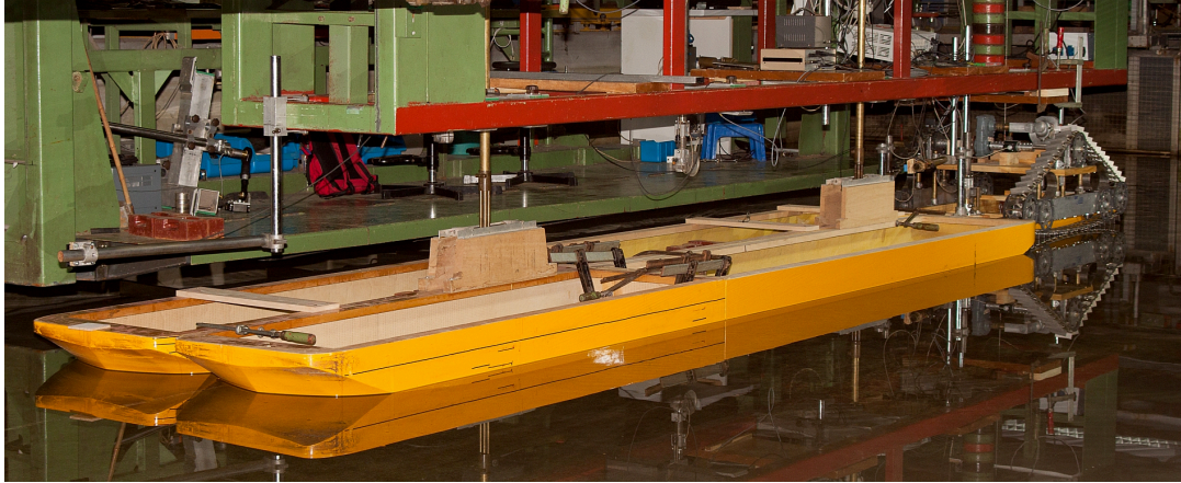
Abb. 6.6: Schubverband zwei Leichtern beim Propulsionsversuch ( h = 1\text{m} , T_{\text{Leichter}} = 2,8\text{m} )
