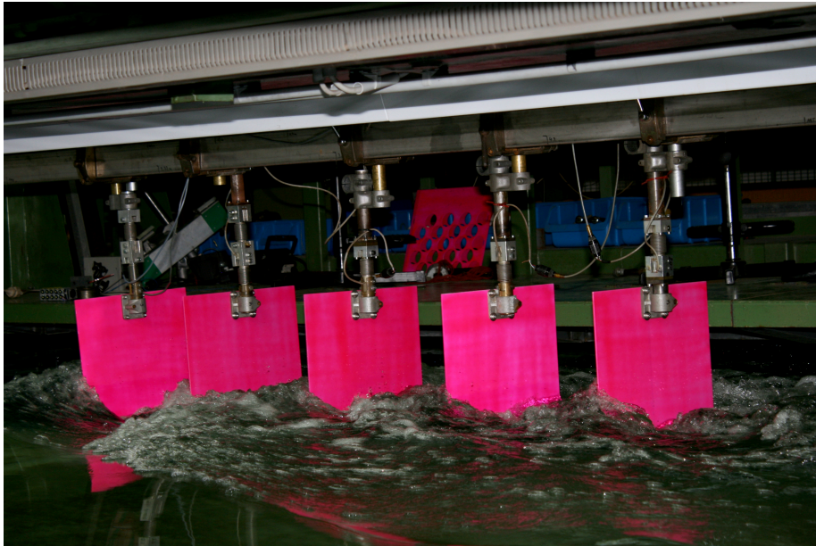
Abb. 4.7: 5 Blätter (Abstand 500 mm, Eintauchung 100 mm, Anstellwinkel 10°); (Fahrtrichtung von rechts nach links)
