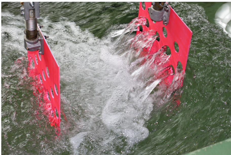
Abb. 4.2: 2 Blätter mit 25 % Perforation; deutlich ist die Durchstömung des vorderen Blatts zu erkennen. (Fahrtrichtung von links nach rechts)
