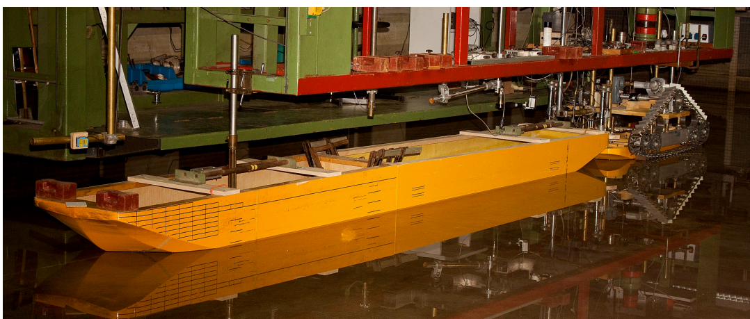
Abb. 6.5: Schubverband mit einem Leichter beim Propulsionsversuch ( h=1 m, T_{\text{Leichter}}=0,8 m)
