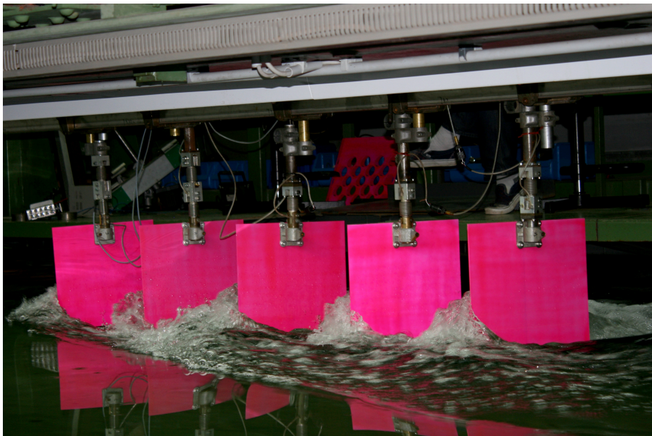
Abb. 4.8: 5 Blätter (Abstand 500 mm, Eintauchung 50 mm, Anstellwinkel 30°); (Fahrtrichtung von rechts nach links)
