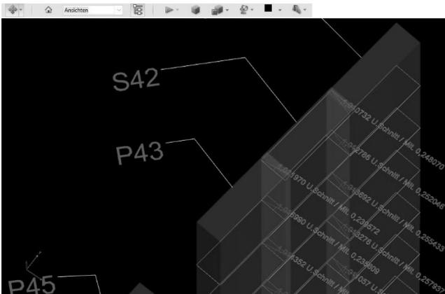
Abbildung 7: Automatisierte, geometrische Überschneitprüfung der Schlitzwandlamellen zueinander
