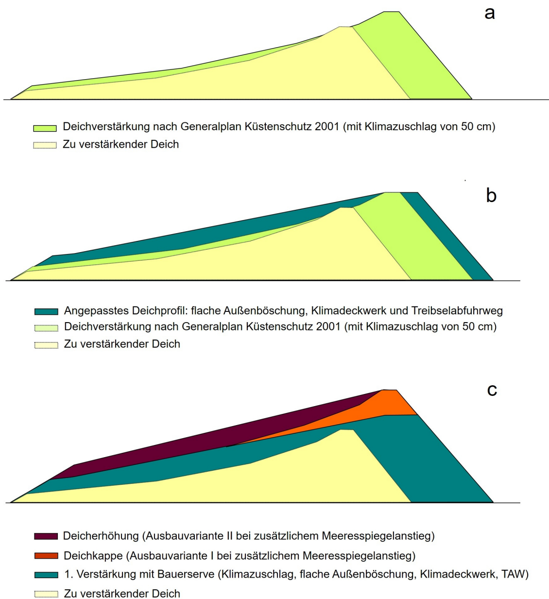
Abbildung 4: Das Konzept Klimadeich.
