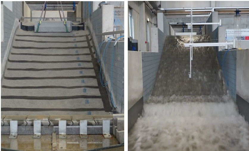
Abbildung 2: Modelldeich: links: Carbonrovings auf Geotextil vor Einbau einer Deckschicht; rechts: Modelldeich mit Deckschicht bei Überströmung
