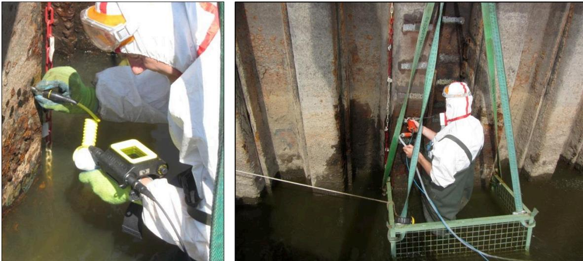
Bild 8: Mehrfachecho-Ultraschall-Gerät, Feldtest Tangermünde 2014
