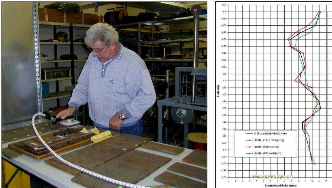
**Bild 5:** Wanddickenmessung mit pulsierendem Wirbelstrom, Labortest
