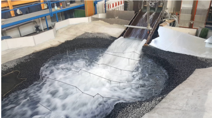
Abbildung 3: Modellbereich mit beweglicher Sohle -Unterstromseitige Ansicht- (Schussrinne, Sprungschanze, Dammfuß und „Plunge Pool“-Bereich).
