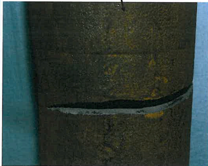
Bild 11: Risslage im Rundstab
