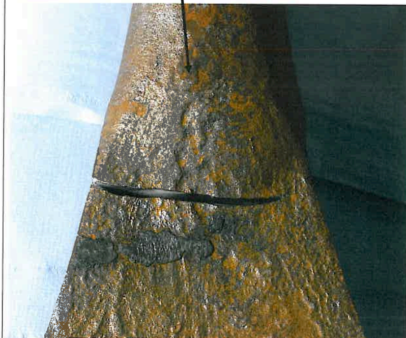
Bild 12: Risslage im Spaten
