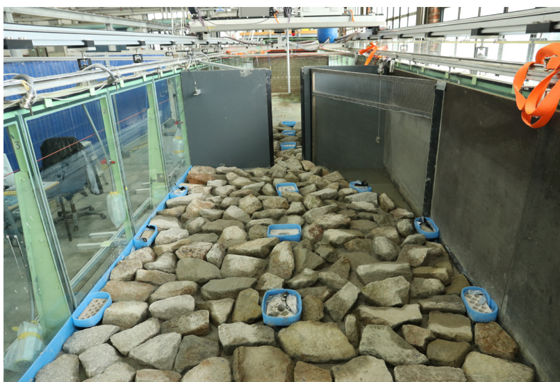
Bild 1: Interpolation der gemessenen Fließgeschwindigkeit im Vertikalprofil bei rauer Sohle mit Blick in Fließrichtung (links), raue Sohle im Aufbau (rechts).
