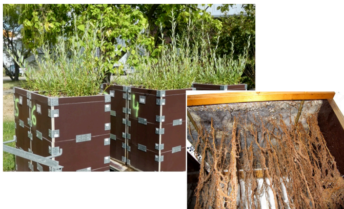
Bild 1: Testen der Durchwurzelbarkeit des abbaubaren Geotextils.
