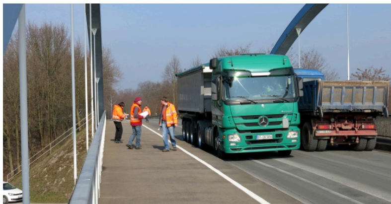
Bild 1: Kalibrierung der Messeinrichtung durch Befahren der Brücke mit gewogenen Schwerfahrzeugen.
