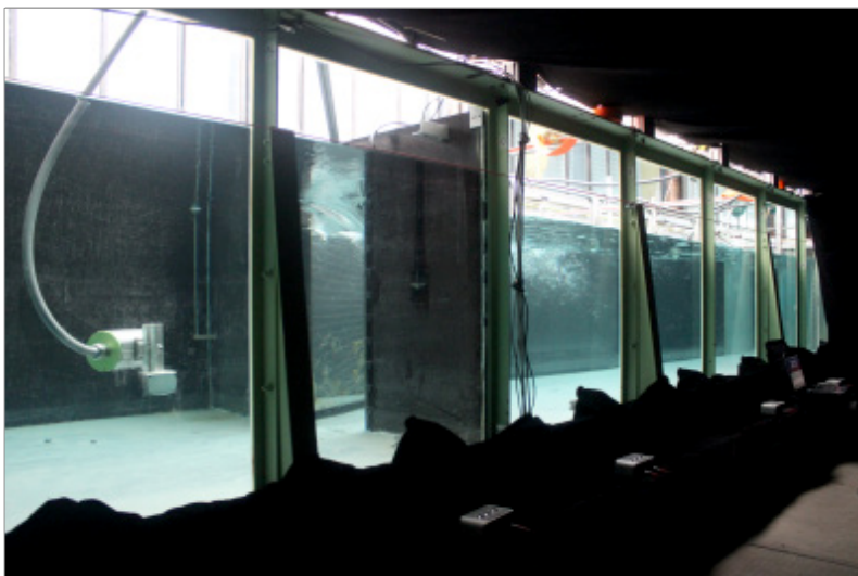
Bild 1: Aufbau des ethohydraulischen Versuchs zur Untersuchung von Fischen bei der Passage eines Schlitzes.
