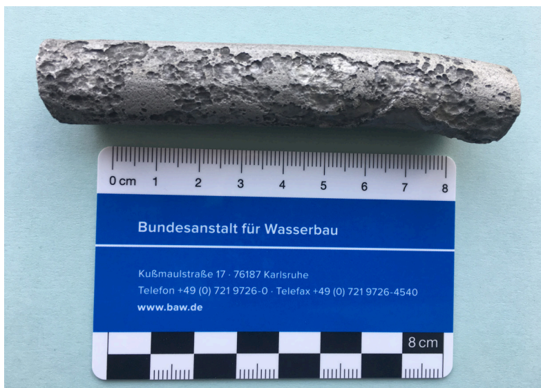
Bild 1: Flächiger Korrosionsabtrag am risskreuzenden Bewehrungsstab (nach dem Beizen).
