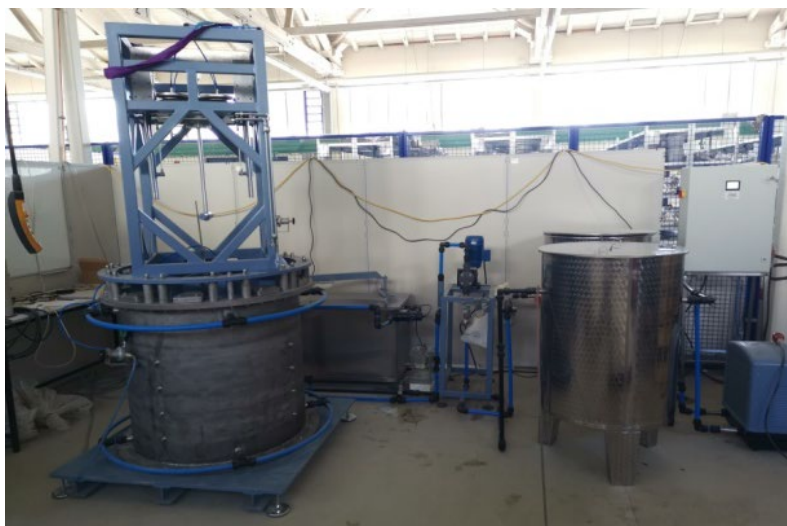
Bild 1: Neuer Versuchsstand auf dem Gelände der BAW zur Untersuchung des chemischen Angriffs auf Verpressanker.
