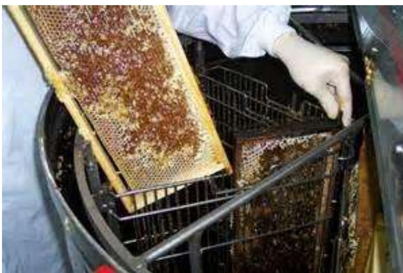
*Figura 17: Centrífuga para separación miel-cera.*
