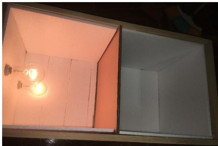
Figura N° 13. Caja térmica con aislante de poliestireno expandido.
