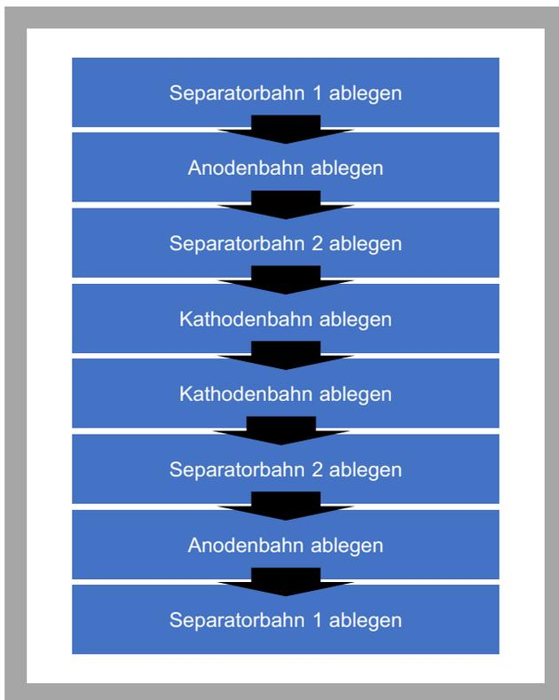
Abbildung 5-9 Stapelbildungsablagereihenfolge
