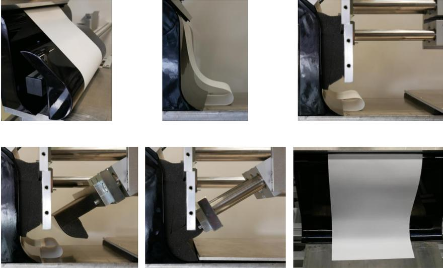
*Abbildung 7-41 Stempelabfolge Separatorbahn*
