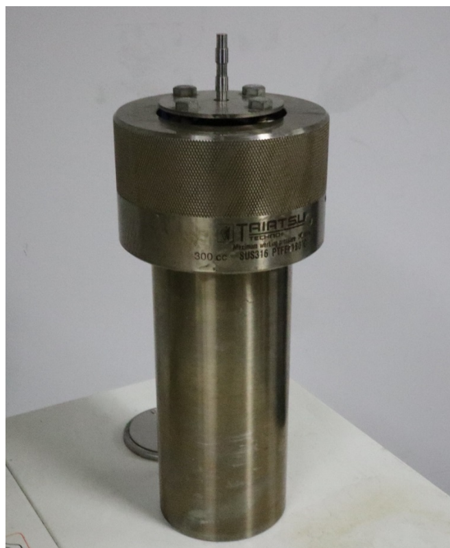
図 3.17 高周波超音波アシスト水熱合成法に用いる反応容器
