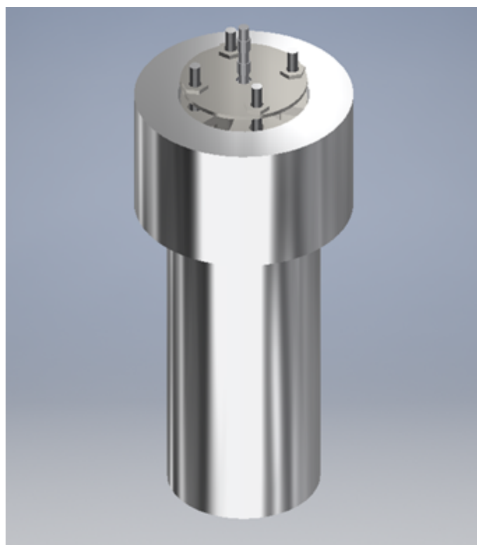
図 3.14 高周波振動子を取り付けたオートクレーブ
