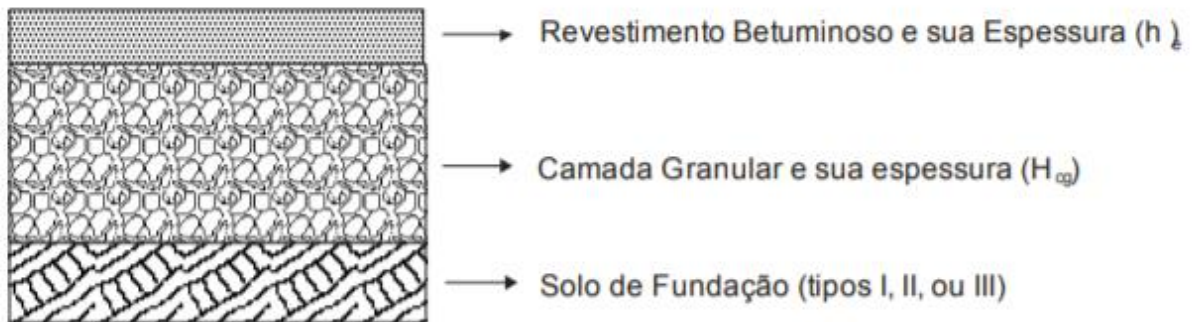
Figura 2.11 – Estrutura de referência do DNER PRO 269/94 (Manual de Restauração – 2006 – DNIT).
