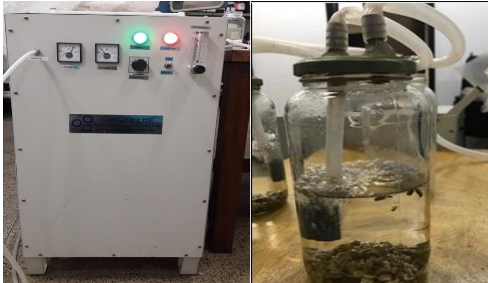
Figura 7. Equipamento produzido para geração do ozônio (esquerda) e coluna cilíndrica onde se realiza a ozonização (direita). Foto: Rogerio Carvalho.
