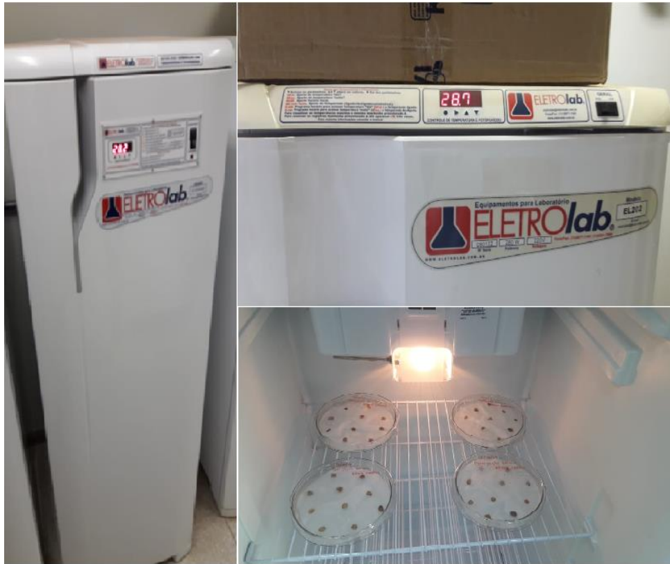
Figura 8. Câmara de germinação tipo B.O.D. contendo o teste de germinação das sementes de Genipa americana L. Fonte: autoral.
