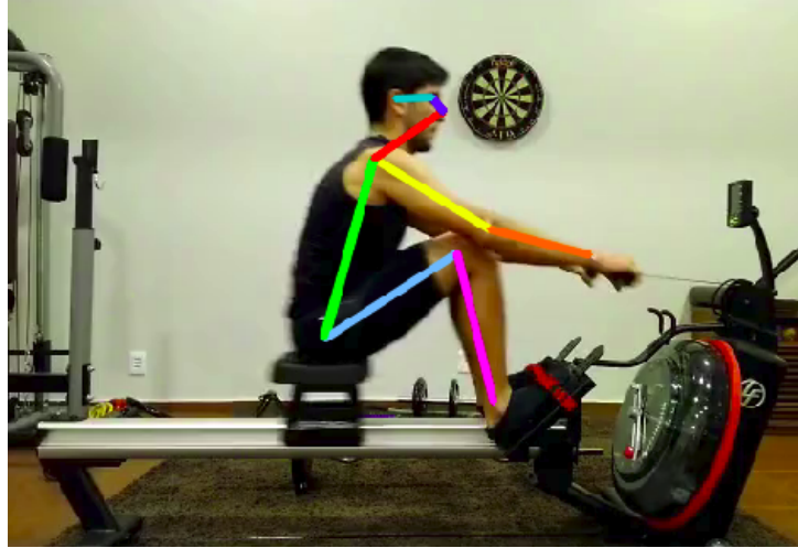
Figura 6 – Resultado do algoritmo de estimação de pose usando a rede neural da OpenPose para 18 pontos de articulação do modelo COCO.
