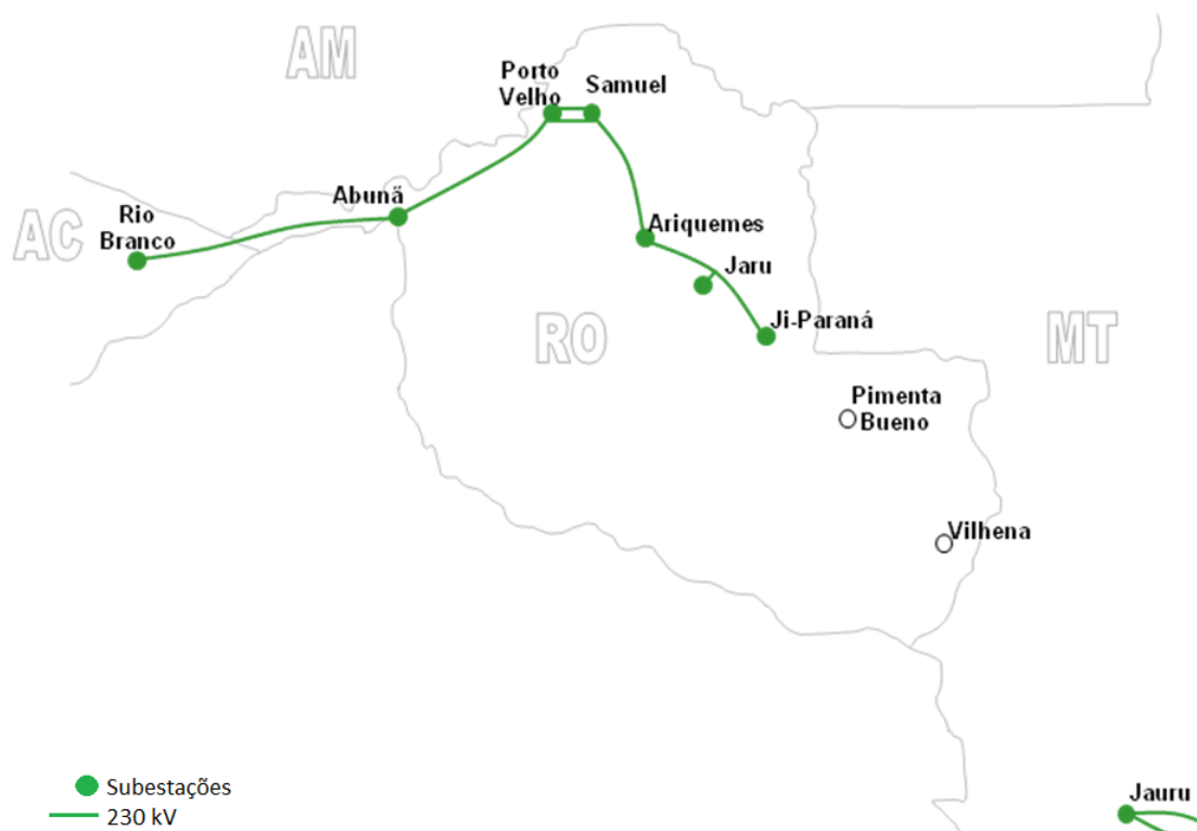
Figura 5 – Diagrama unifilar da área Acre/Rondônia - Configuração isolada do restante do Sistema Interligado Nacional - SIN
