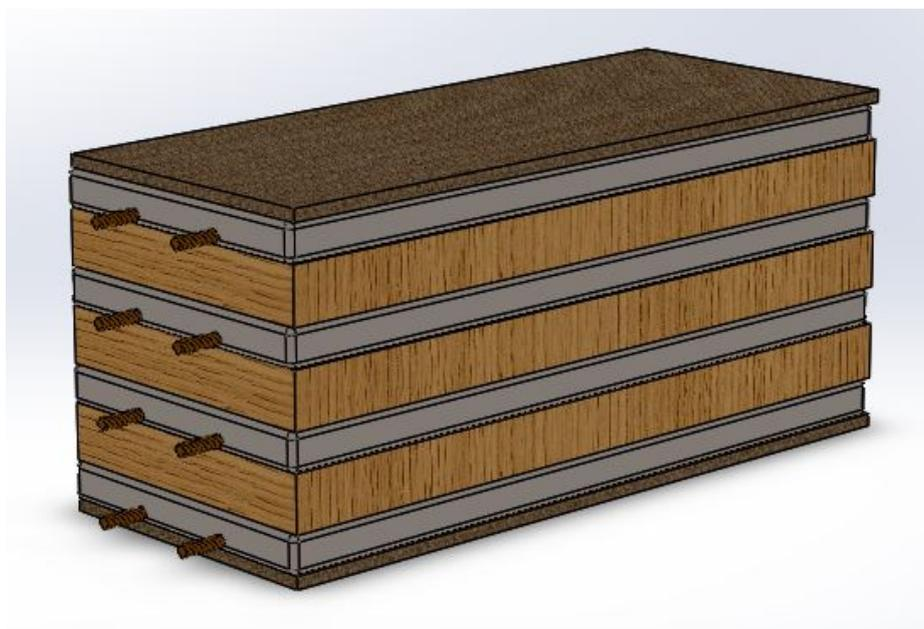
Figura 3.21: Formato do posicionamento do corpo de prova.
