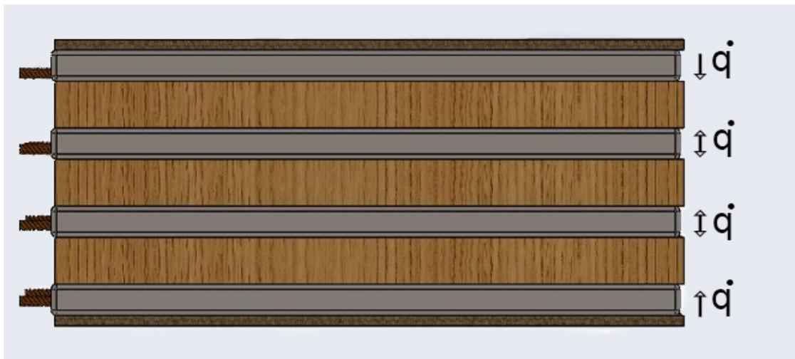
Figura 3.5: Sentido do fluxo de calor.
