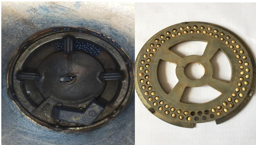
**Figura 4.** Mecanismo dosador de disco horizontal convencional.
