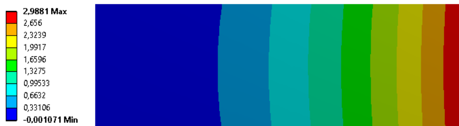
Figura 27: Comportamento via MEF de placa sob momento (Configuração: Células).
