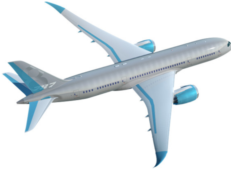
Figura 1: Presença de painéis-sanduíche (em azul) no Boeing 787. Fonte: www.boeing.com
