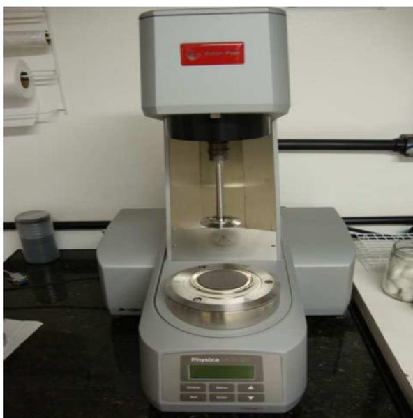
Figura 31 – Reômetro MCR 301 da Anton Paar.
