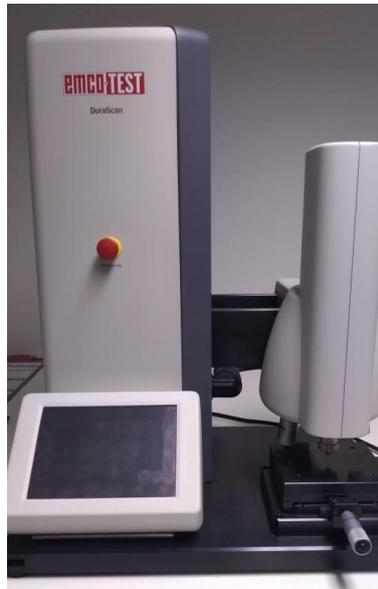
Figura 3.2 – Microdurômetro *DuraScan*, da EMCOTESTE.
