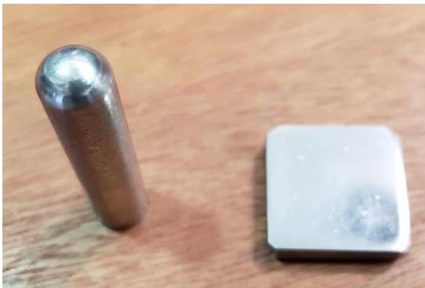
Figura 3.4 – Sapata e a pastilha de material ASTM a352 CA6NM
