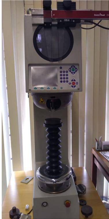
Figura 3.3 - durômetro universal, da Zwick/Roell.
