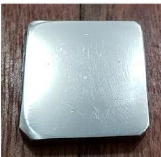
Figura 3.8 - Amostra de a352 CA6NM em formato de pastilha
