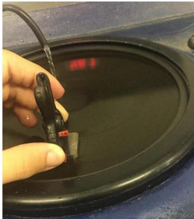
Figura 3.1 - Amostra no processo de lixamento na Politriz.
