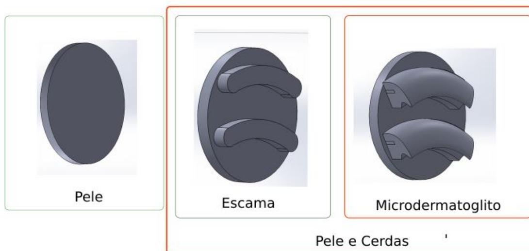
Figura 43: Nomenclatura das três partes que compõem a superfície de atrito discutida
