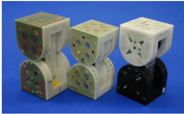
Figura 7: Módulos do M-Tran sendo, da esquerda pra direita, os módulos I de 1998, II de 2002 e III de 2005. Fonte: <https://unit.aist.go.jp/is/frrg/dsysd/mtran3/>, Acessado em 20/09/2018).
