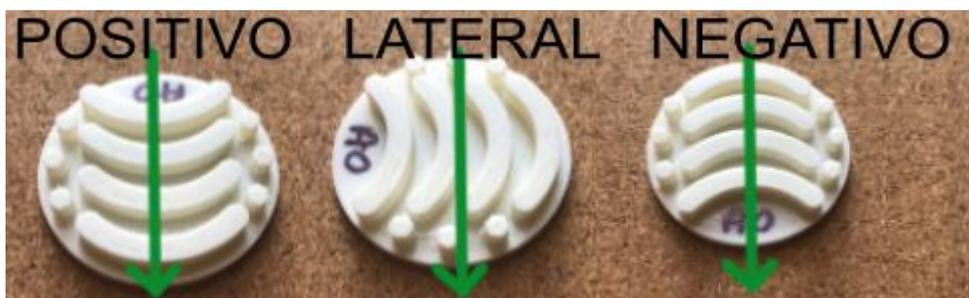
Figura 46: Placa  $A0_1$  nos três sentidos usados para avaliação de anisotropia
