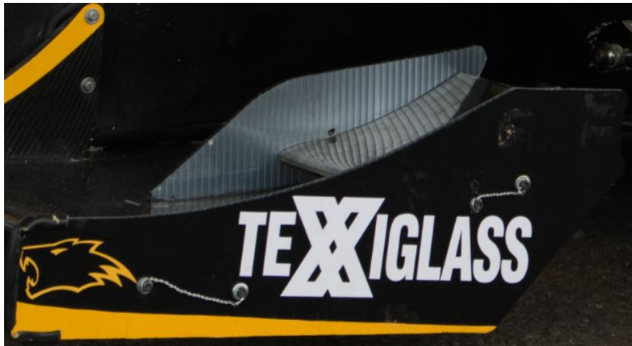
Figura 77 – Exemplo de aplicação de arame de freio no protótipo 2017 (APUAMA, 2017).
