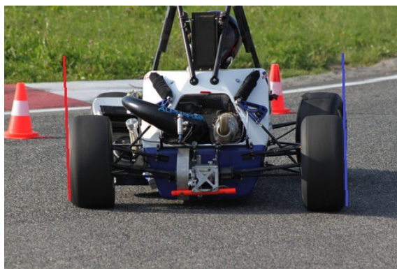
Figura 16 – Exemplo de veículo de Formula SAE com flexibilidade excessiva em membros da suspensão (CLARKE, 2012).
