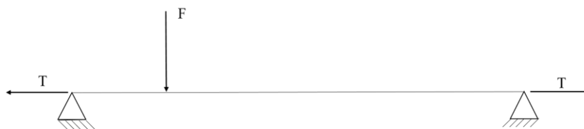
Figura 3-5: Modelo de cabo simplesmente apoiado, com forçamento pontual e tensionado.
