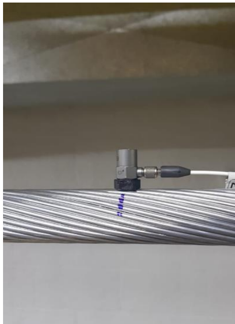
Figura 4-7: Fixação do acelerômetro ao cabo utilizando cera de abelha.
