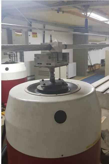
Figura 4-6: Fixação do Shaker e Acelerômetro ao cabo.
