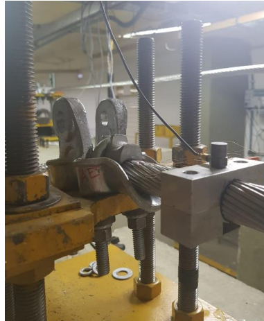
Figura 4-4: Fixação engastada na extremidade direita.
