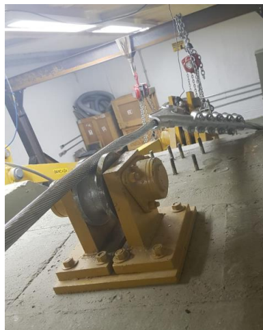
Figura 4-3: Fixação simplesmente apoiada na extremidade esquerda
