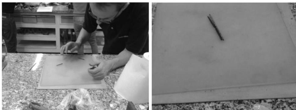
Figura 3.9 - Determinação do limite de plasticidade, Massad (2016).
