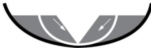
Figura 3.7 - Ensaio de Casagrande para determinação do Limite de liquidez Casagrande, Massad (2016).
