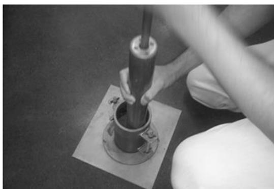
Figura 3.10 - Ensaio de Compactação, Massad (2016).
