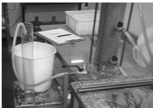
Figura 3.11 - Coleta de vazão de percolação no ensaio de permeabilidade, Massad (2016).
