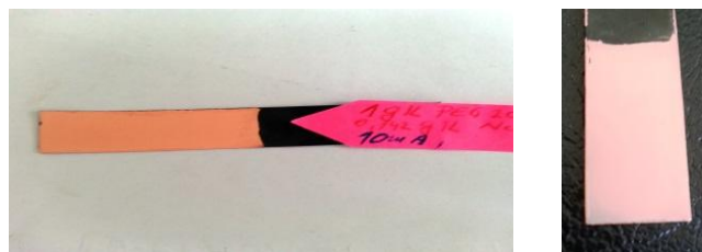
Sl. 5. Film Cu sitnozrne strukture elektrodeponovan na bakarnom supstratu u prisustvu aditiva PEG + Cl-
