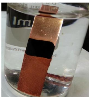
Sl.4. ED film Cu na bakarnom supstratu istaložen iz kupatila I (sa Cl-), pri gustini struje j=40 \text{ mA}\cdot\text{cm}^{-2} .
