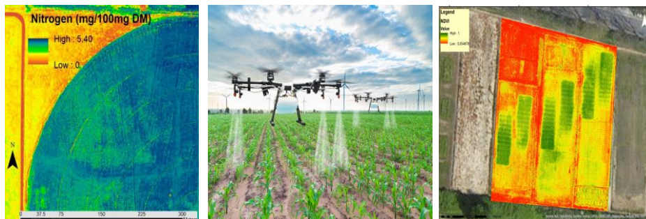
Slika 17. Procene sadržaja azota (N) na parcelama : ovas (levo) i travu golf terena (desno) (sadržaj N je u mg/100mg DM, rezolucija: 6 inch/pixel) , [51], [82].
