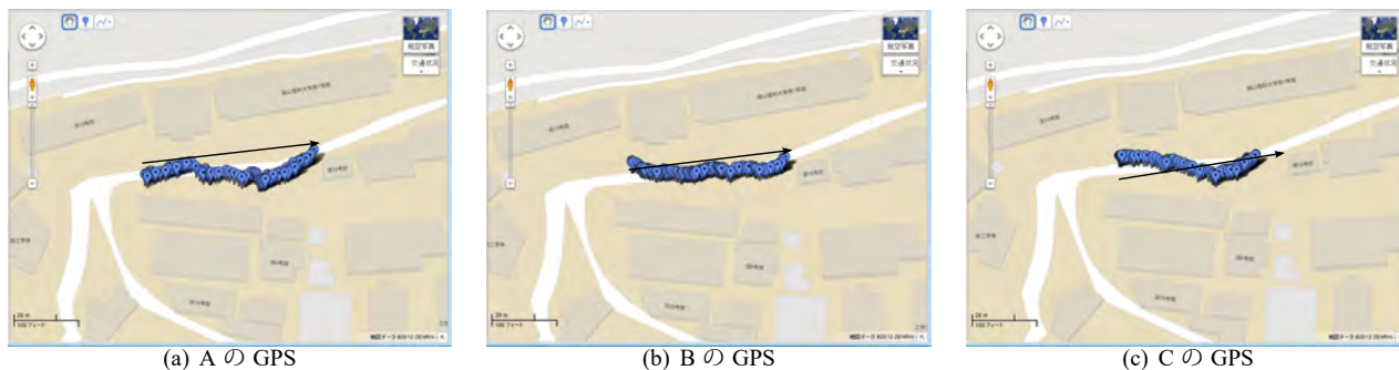
図 7: F から S に移動しながら位置の測定をした結果
