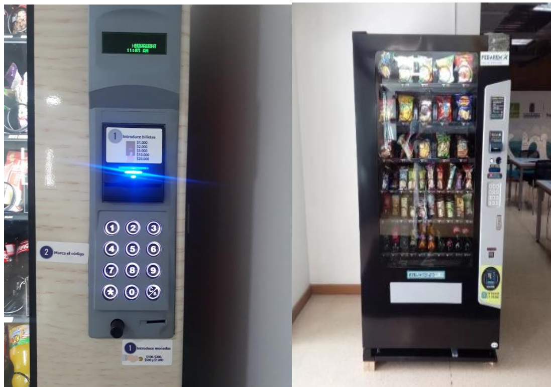
Figura 43. Máquina dispensadora de fácil uso . En la imagen se muestra una máquina que tiene audio y braille para que tengan acceso las personas con discapacidad. Tomado de salida de campo a fundación CRAC.
