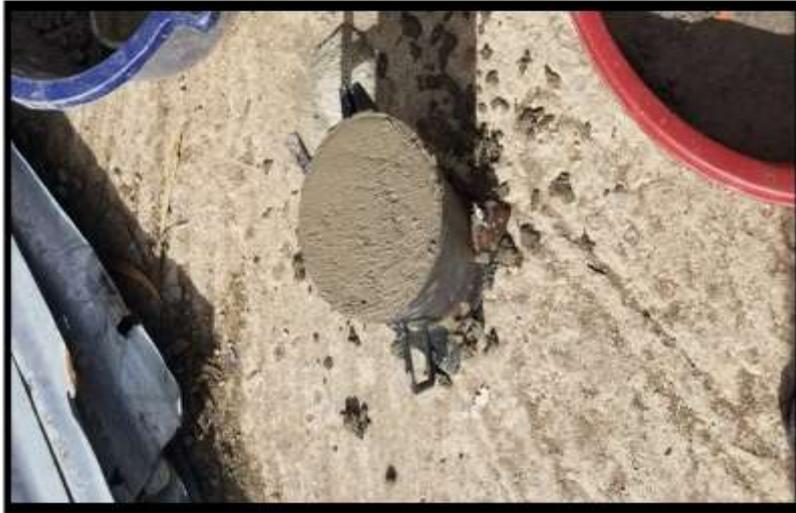
**Figura N° 19.** Espécimen con Cemento Quisqueya Portland tipo I.
