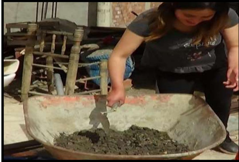
**Figura N° 17.** Se muestra la homogenización de la muestra contenida con Cemento Quisqueya Portland tipo I.
