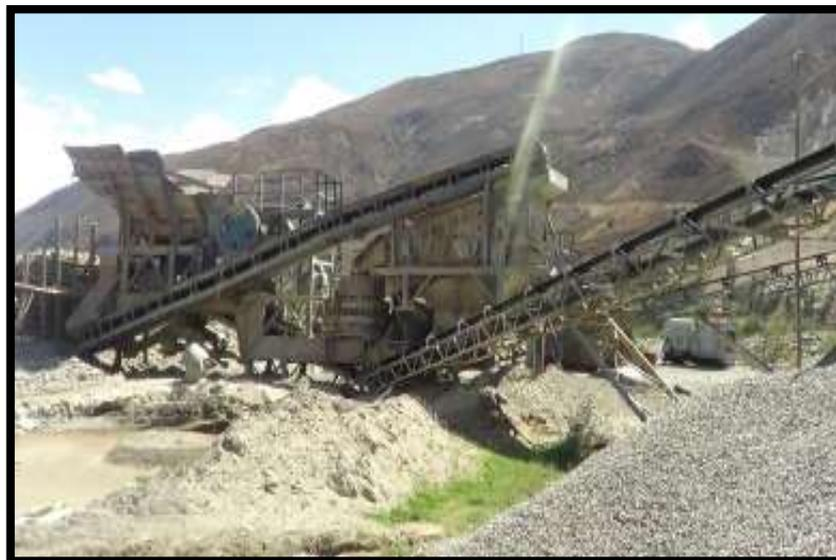
**Figura N° 4.** Máquina chancadora, para la extracción de piedra chancada.
