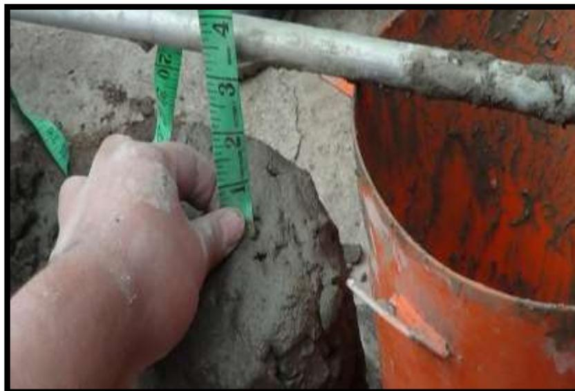
**Figura N° 13.** Slump, cemento Sol Portland tipo I.
