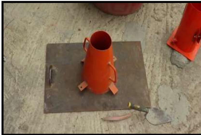
**Figura N° 7.** Cono de Abrams y placa de acero liso.
