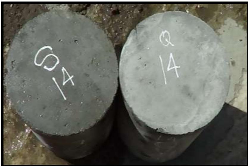
**Figura N° 24.** Muestras de cementos: Sol y Quisqueya Portland tipo I, después de realizar el curado a los 14 días.
