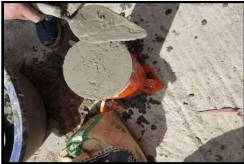
**Figura N°18.** Enrazamiento de la muestra con cemento Sol Portland tipo I.
