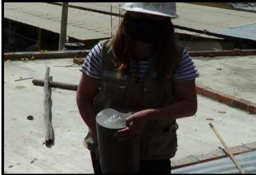
**Figura Nº 26.** Espécimen de concreto, realizado con cemento Quisqueya Portland tipo I, después del curado la edad de 28 días.
