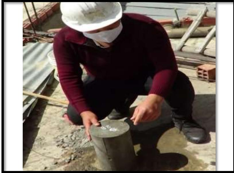
**Figura Nº 25.** Espécimen de concreto, realizado con cemento Sol Portland tipo I, después del curado la edad de 28 días.
