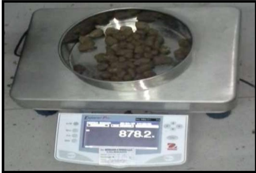
**Figura N° 5.** Balanza con sensibilidad de 0,1 g.
