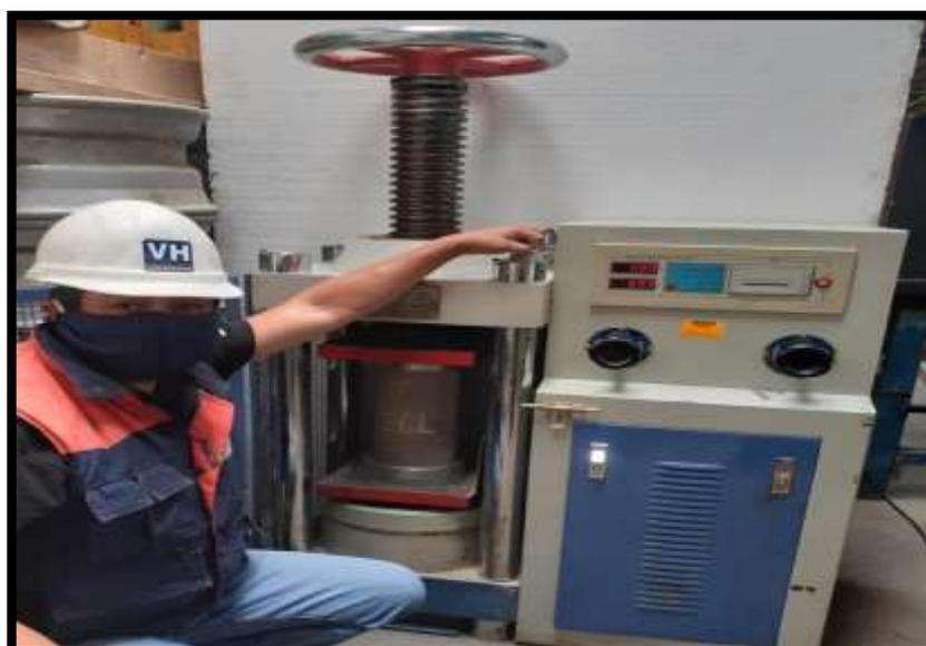
**Figura N° 28.** Se procede a colocar la probeta con cemento Sol Portland tipo I a la edad de 7 días, para determinar su resistencia.
