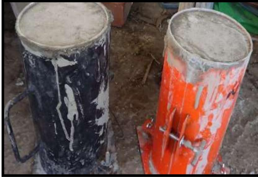
**Figura N° 21.** Desmoldación de las probetas.
