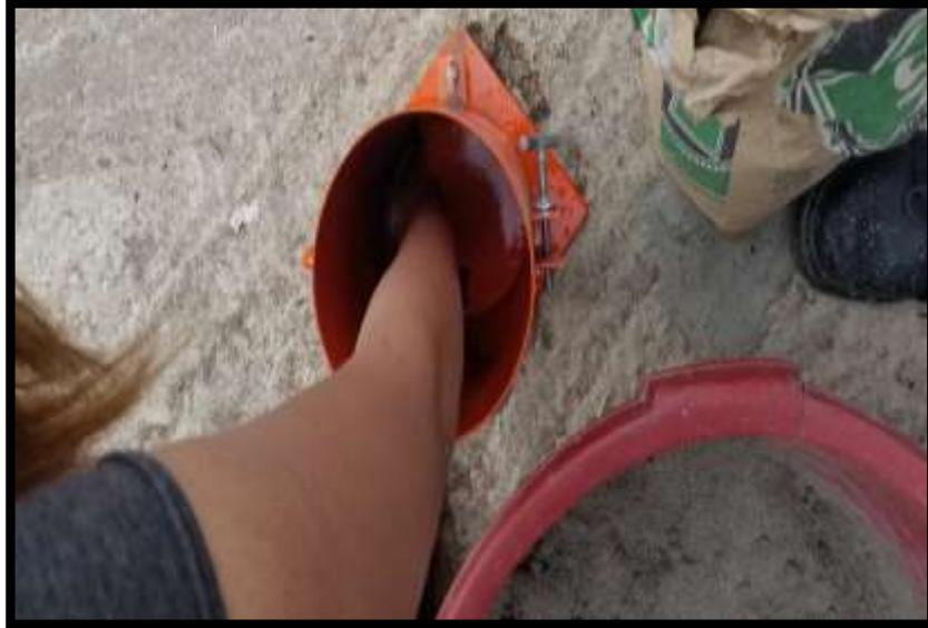
**Figura N° 8.** Se humedeció el molde con gasolina, para que el concreto no se adhiriera posteriormente.
