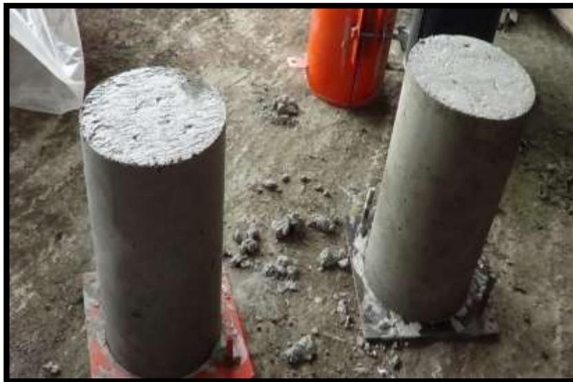
**Figura N° 22.** Desmolde de las probetas con cementos: Sol y Quisqueya Portland tipo I.
