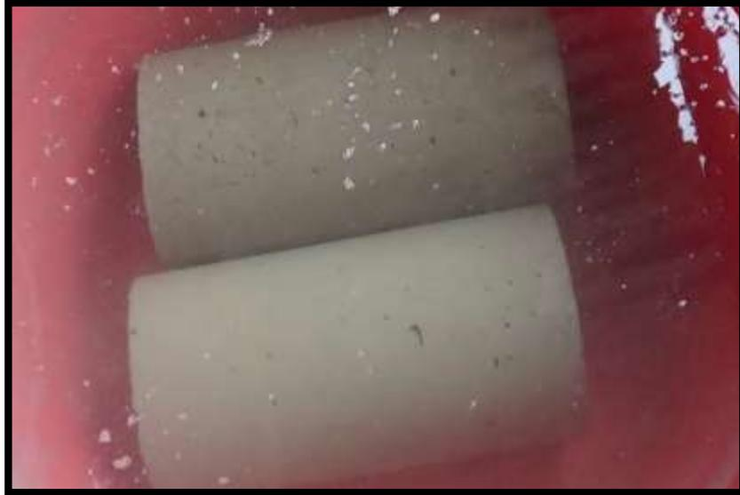
**Figura N° 23.** Curado de las probetas.
