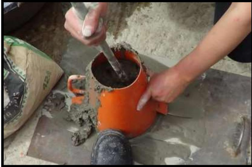
**Figura N° 12.** Procedimiento para medir el slump.
