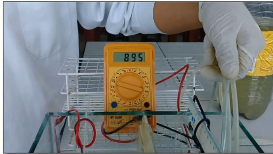
Figura A4: Medición de MiliVoltios en la celda microbiana agregando 1,398 (L/min) de oxígeno.
