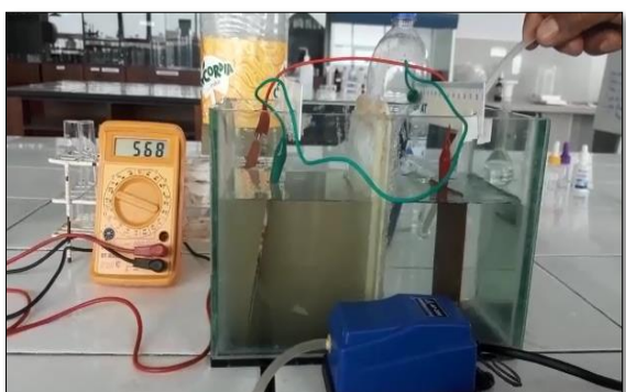
Figura A3: Medición de MiliVoltios en la celda microbiana agregando 0,699 (L/min) de oxígeno.
