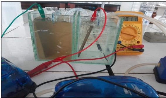
Figura A4: Medición de MiliVoltios en la celda microbiana agregando 1,398 (L/min) de oxígeno.
