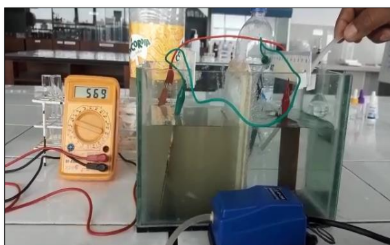
Figura A3: Medición de MiliVoltios en la celda microbiana agregando 0,699 (L/min) de oxígeno.
