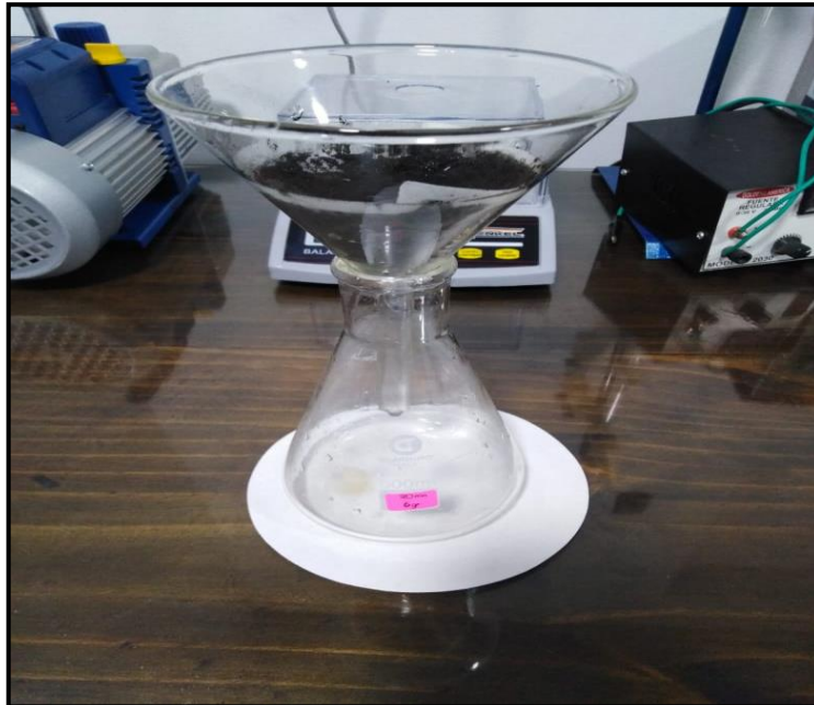
Figura N° 10: Filtración de la muestra obtenida con grafeno. Fuente: Elaboración propia, 2019.
