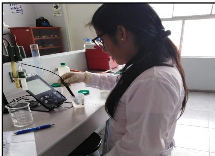
Figura N° 16: Medición de los parámetros físicos con el multi-parámetro. Fuente: Elaboración propia, 2019.
