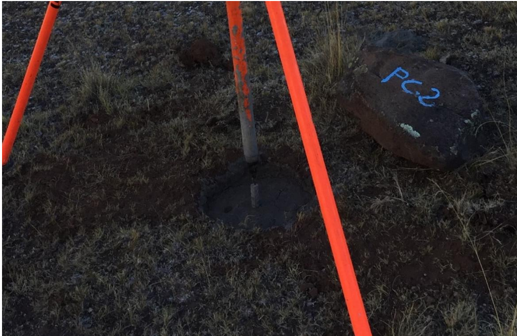
Figura 23. Punto de control geodésico
