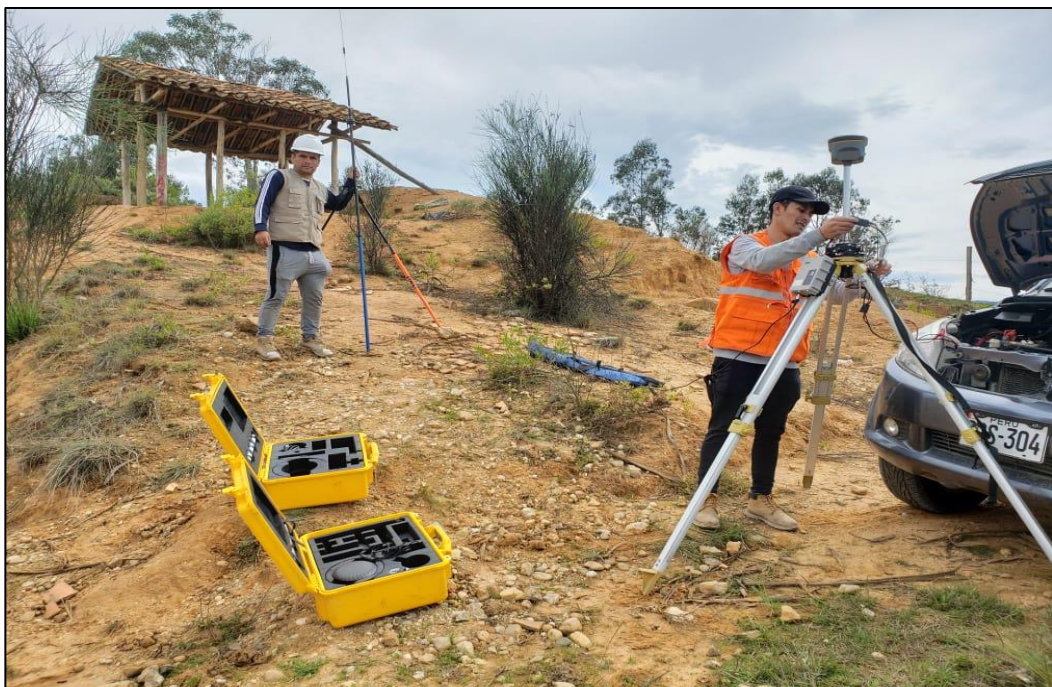
Figura 22. GPS Diferencial usado para los puntos geodésicos
