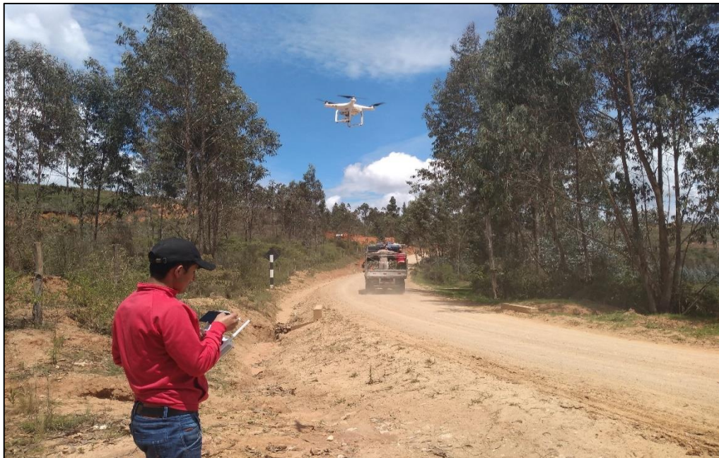
Figura 25. Drone durante el levantamiento.
