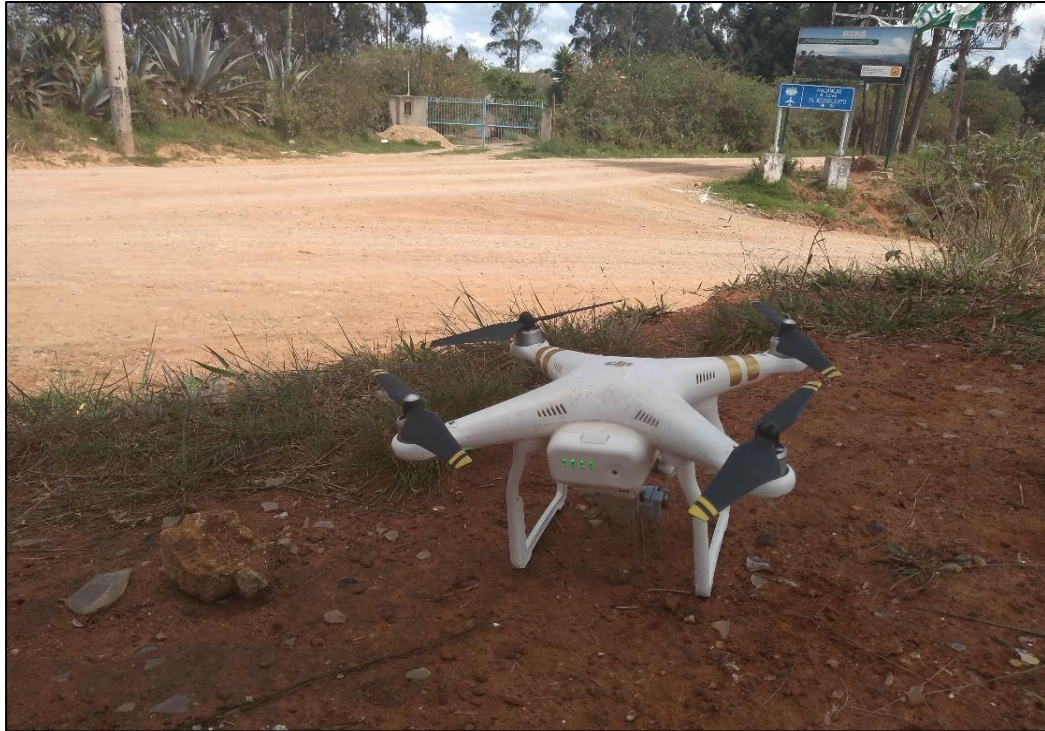
Figura 21. Dron usado para fotogrametría.
