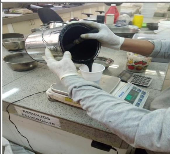
DOSIFICACIÓN DE EMULSIÓN ASFÁLTICA
