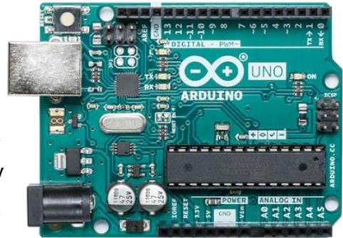
**Figura 14:** Arduino Placa.
