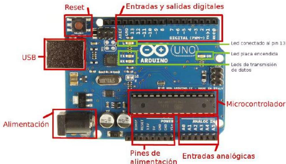
**Figura 15:** Arduino Placa.
