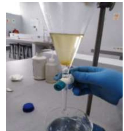
Figura 43. Separación de hidrocarburo
