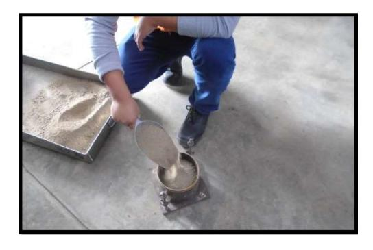
Vista del proceso del ensayo para encontrar el peso unitario, la muestra se coloca en la olla y se enrasa, para luego pesarlo y hacer un simple cálculo matemático
