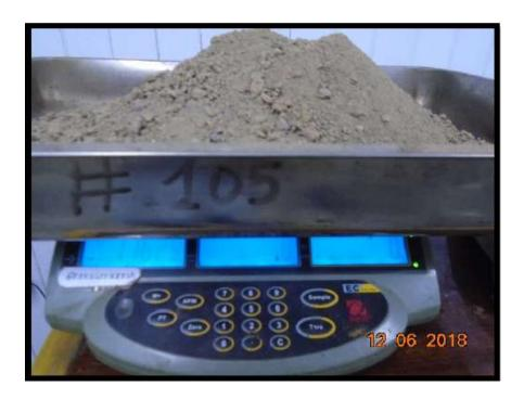
Vista del material propio, utilizando la balanza electrónica de precisión 1 gr, obteniendo el peso para preparar la mezcla de los diseños requeridos, se pesó varias muestras de material propio para obtener la tanda para la mezcla.
