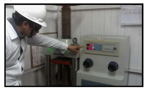
Vista del ensayo de comprensión de la muestra, se observa la maquina universal ensayando con una velocidad controlada hasta alcanzar la rotura de la muestra registrando los valores en KN que luego será convertido a kg/cm2.
