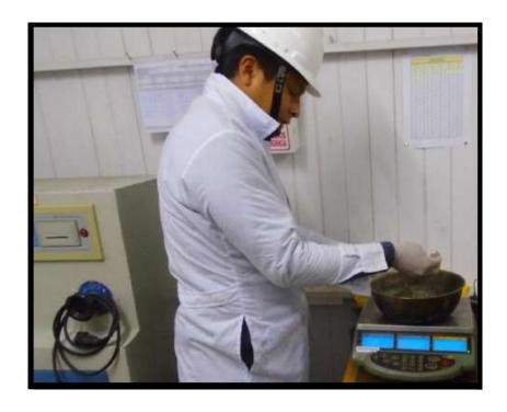
Vista pesando la muestra para el ensayo del peso específico, la medición se hace en una balanza electrónica de precisión de 1g.
