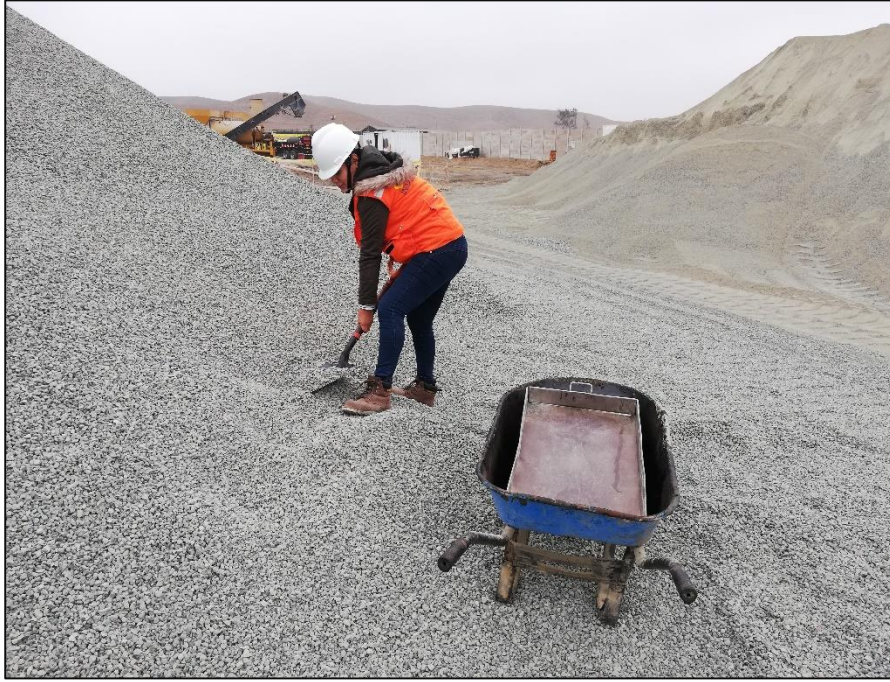
Figura N°: 4 Materiales empleados de la carretera - Agregado grueso
