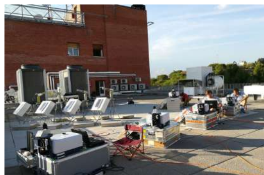
Figura 1. Intercomparación de la instrumentación de la campaña MEGEI-MAD (espectrómetros EM27/SUN y fotómetros CIMEL) en la sede central de AEMET.
