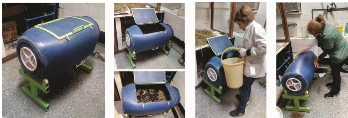
**Fig.2:** Prototipo de la "bokashiera" terminado, en el proceso de llenado y mezclado
