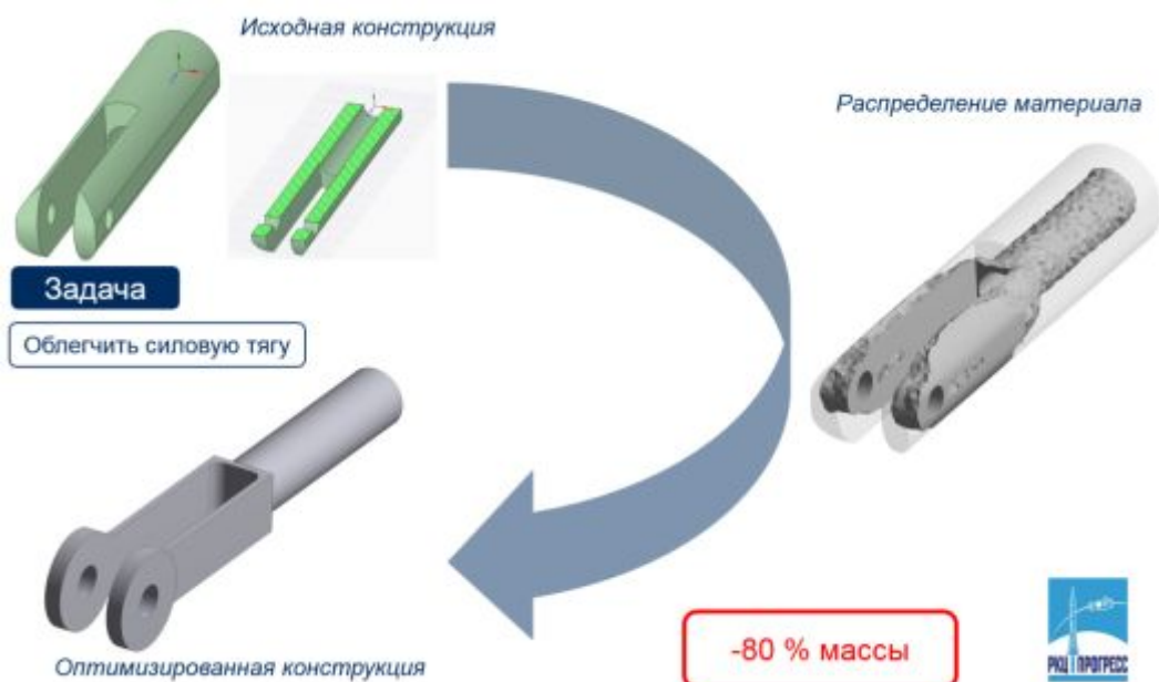
Рис. 1. Пример использования топологической оптимизации при изготовлении традиционными средствами производства
