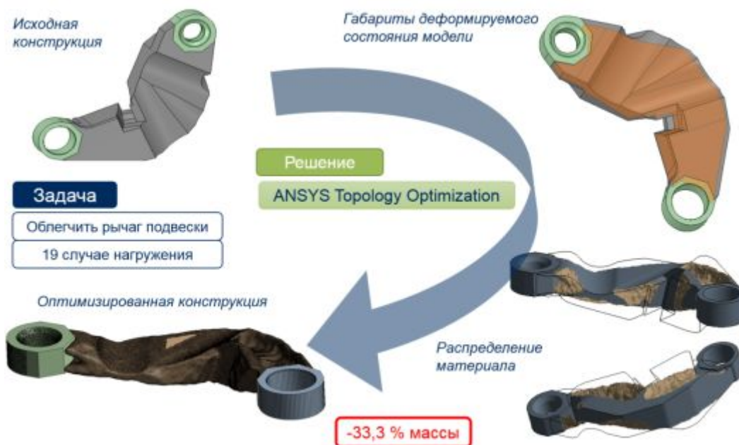
Рис. 2. Пример использования топологической оптимизации при изготовлении аддитивными средствами производства
