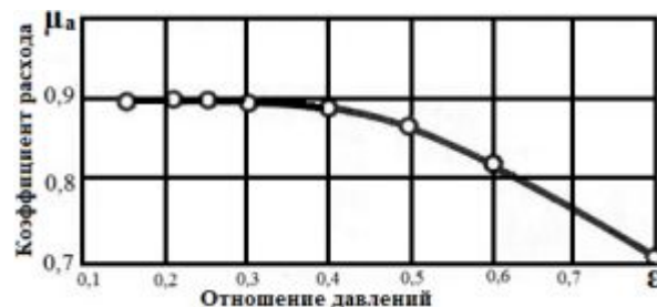
Рис. 3. Зависимость коэффициента расхода активного сопла от отношения давления за соплом к давлению торможения на входе в сопло
