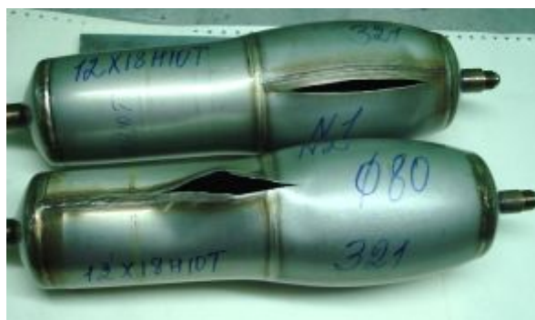
Рис. 2. Разрушение образцов диаметром 80 мм при испытаниях
