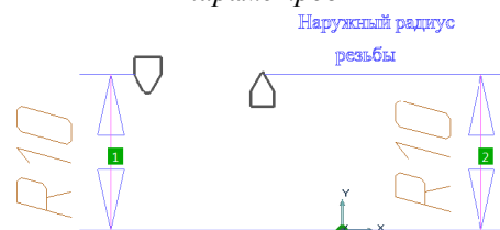
Рис. 2. Параметрические модели резов для нарезания метрической резьбы на стержне (слева) и в отверстии (справа)
