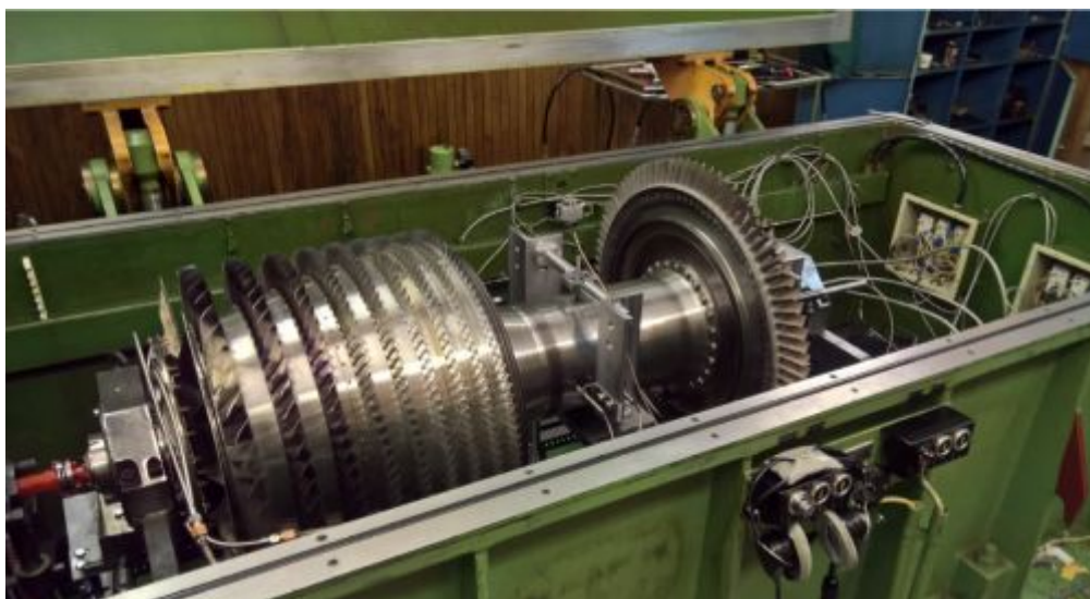
Рис. 1. Установка для высокочастотной балансировки роторов
