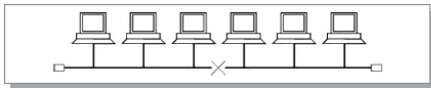
Рисунок 1.5 Обрыв кабеля в сети с топологией шина
