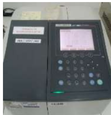
Gambar 3.16. Pengukuran Nilai Absorbansi pada Sampel menggunakan spektrofotometri UV-Vis (Dokumentasi Pribadi, 2020)
