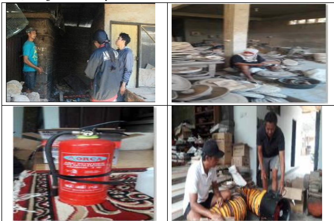
Gambar 2. Sistem Pengisap Debu dan Alat Pemadam Kebakaran
