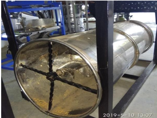
Gambar 5. Turbin Sudu Tidak Seragam.
